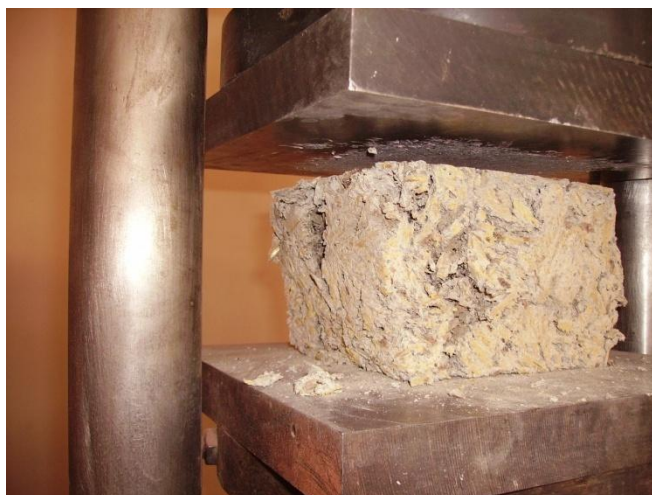
Рис. 2. Характерное разрушение арболита
