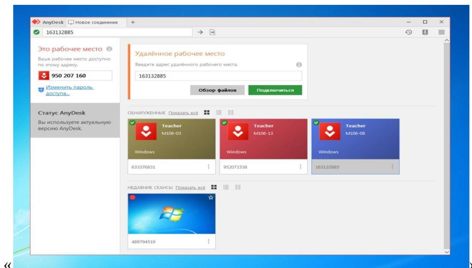
**3.2** Затем на управляющем компьютере вводим адрес (цифровой код компьютера к которому будем подключаться) и вводим в форму по центру окна «Удалённое рабочее место». И жмём зелёную кнопку «Подключиться».
