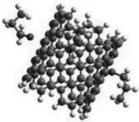
Рис. 7. Модель адсорбционного взаимодействия нанотрубки (6, 6) и двух молекул нормального пропанола.
