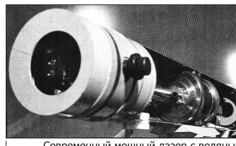
Современный мощный лазер с водяным охлаждением
