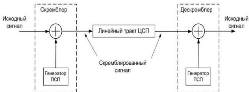
Рисунок 3.35 – Схема скремблирования цифрового сигнала
