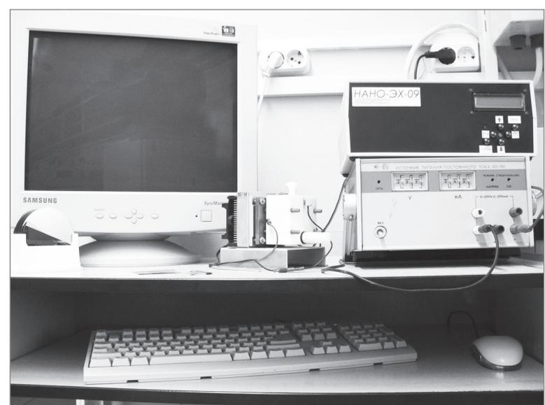
Установка синтеза нанопористых пленок
