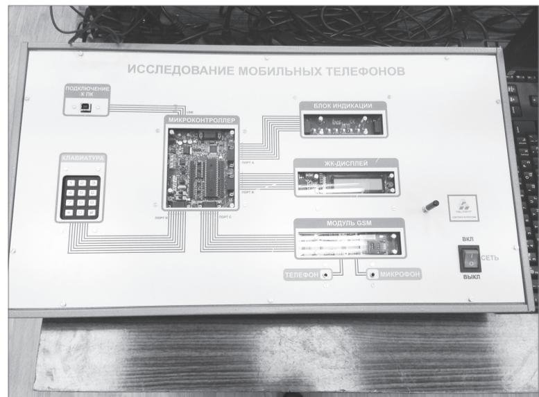
Лабораторная установка «исследование мобильных телефонов»
