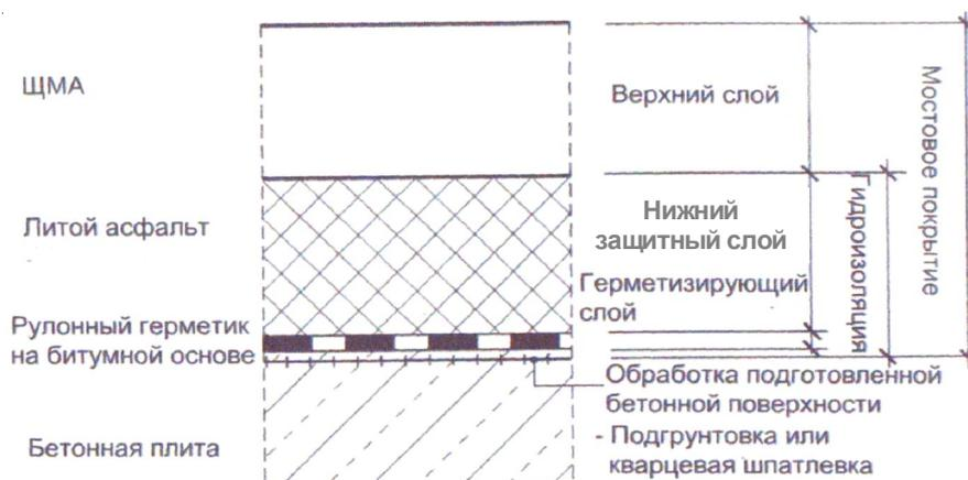
Рис. 1. Конструкция мостового покрытия на бетонной плите
